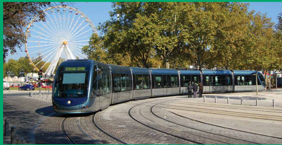
Tramvaj u Bordou sa napajanjem sa tla (APS sistem), 2008. Foto: Plini/Wikimedia Commons.
